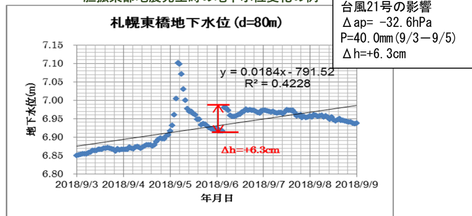
胆振東部地震発生時の地下水位変化の例
